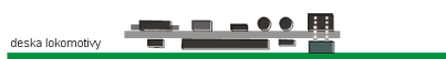
Horní strana dekodéru je vidět shora, kolíky konektoru na desce lokomotivy procházejí deskou dekodéru zdola do konektoru dekodéru
